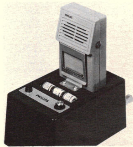
Afb. 3. Lader, waarin de ontvanger normaal in bedrijf kan blijven. Vóór de ontvanger een reservebatterij in geladen conditie. Links een onderbrekingsknop voor het externe alarm, rechts een verklipperlampje.
